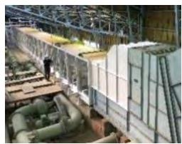
高潮・高波・強風・津波に関する模型実験を行う、国内最大級の風洞水槽です。台風等の風を起こす送風装置、波・流れを起こす造波装置・回流装置を使い、自然災害から大都市や港湾を守る研究等を行っています。
