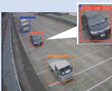
国総研の試験走路において、高さ・俯角・水平角が異なる複数のカメラで撮影した映像を、AIで解析。車両検出、車種判別の精度が向上する画角条件を検討。
