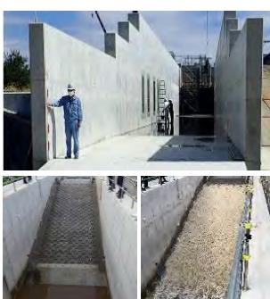
大規模堤防模型実験水路では、実物に近いスケールの模型を用いて、堤防等の河川構造物に作用する外力とそれらの破壊機構を検討し、合理的な河川構造物の設計法について検討しています。
