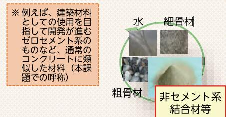
コンクリート系新材料の例
