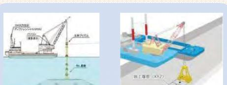
施工履歴データを用いた出来形計測
