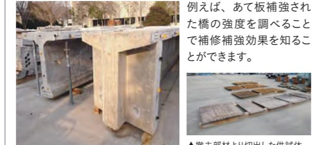
例えば、あて板補強された橋の強度を調べることで補修強効果を知ることができます。
