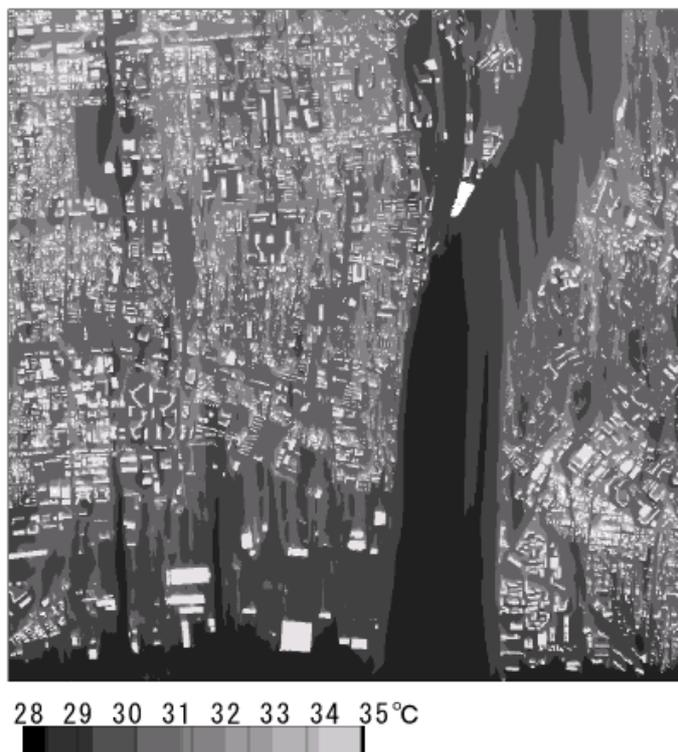
図2 「地球シミュレータ」による海風が荒川河口付近の臨海部の気温分布に及ぼす影響の試算結果（独立行政法人建築研究所足永首席研究員提供）
