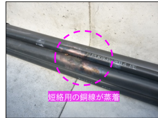
実験後の状態(通信ケーブル・10cm)
