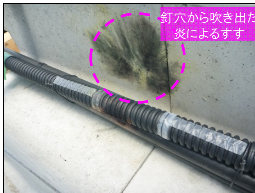
実験後の状態(電力ケーブル)
