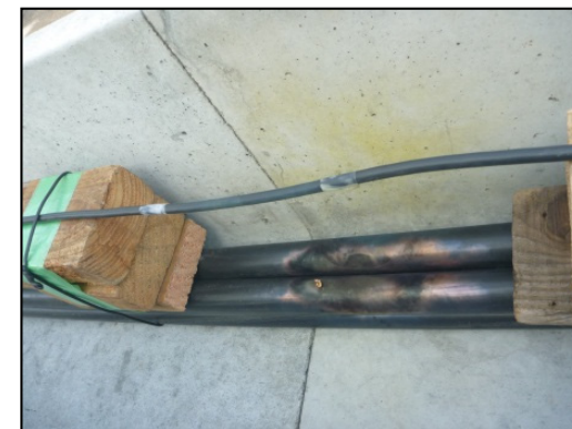
実験後の状態(通信ケーブル・10cm)
