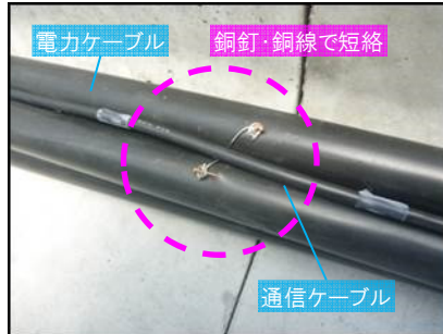
電力ケーブル短絡箇所
