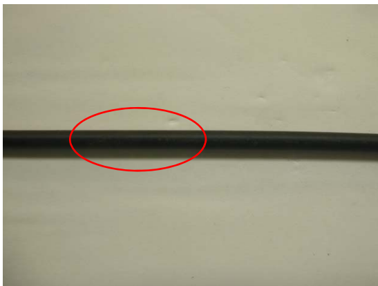
【検証外】支障無い程度の小傷有り
