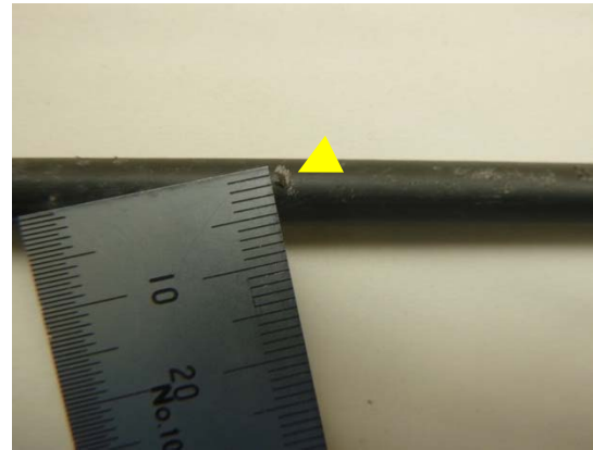
【損傷】 傷の大きさ（長さ）3 mm
