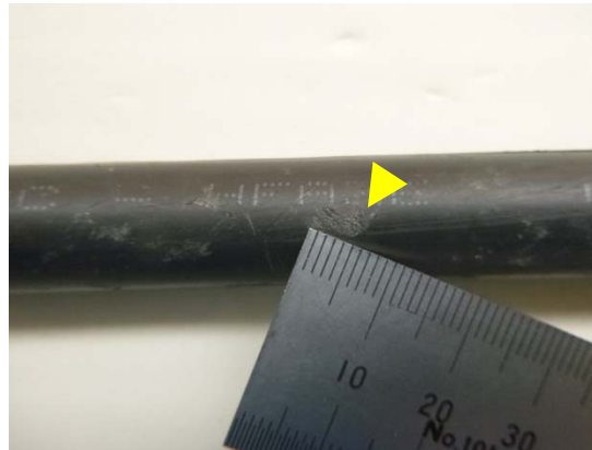
【損傷】傷の大きさ（長さ）5mm
