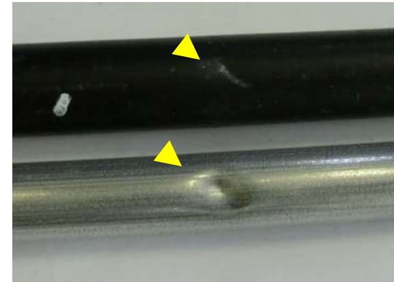
【損傷】外部導体（内部構造）の変形
