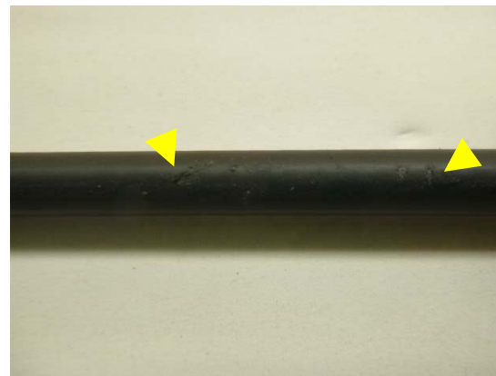
【検証外】小傷箇所の拡大
