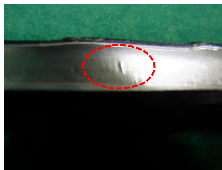
CCP-JF 座屈箇所のアルミシース写真
