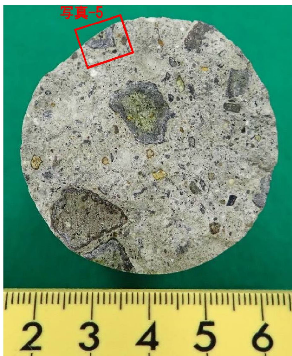
写真-4 コア破断面：天大橋/P9 橋脚/C2
