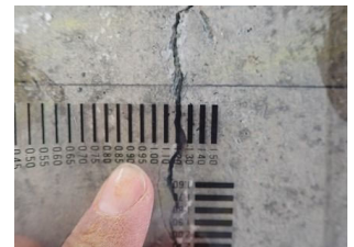
ひびわれ幅: t=1.2\text{mm}
