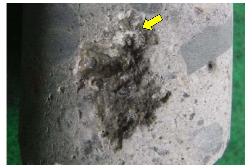
細骨材 (砂) 周囲の白色ゲル (③の拡大)
