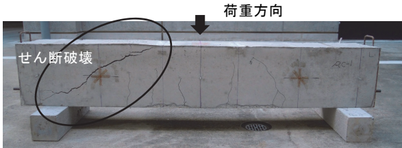
写真-3 鉛直荷重で生じるせん断破壊 (実験)
