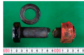
写真-2 不完全ねじ部での破断
