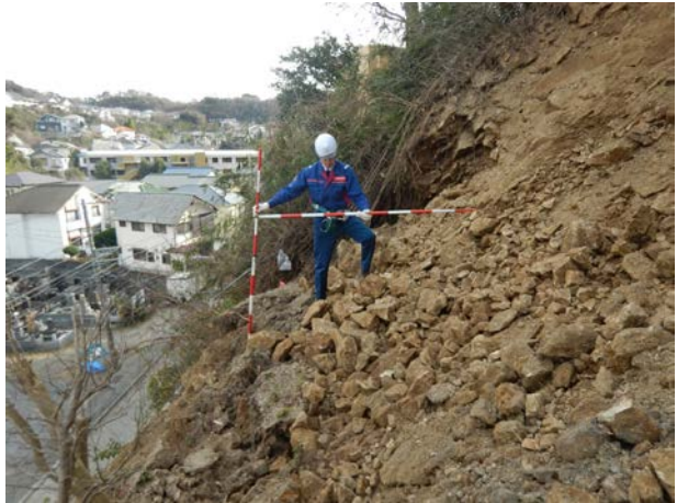
崩壊深:最大1.6m程度, 勾配1:1.4程度
