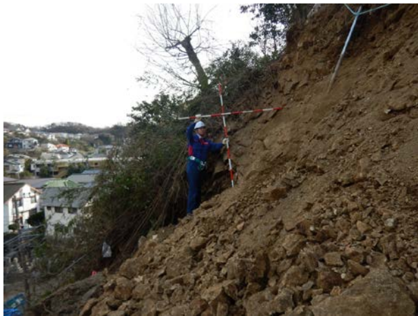
崩壊深:最大1.6m程度, 勾配1:1.4程度
