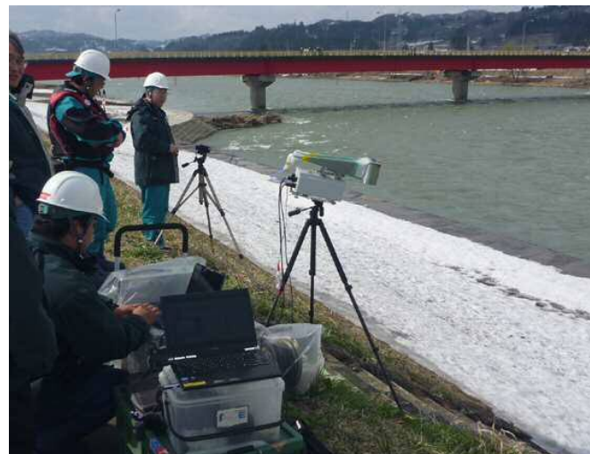
最新式電波流速計 の試験状況
