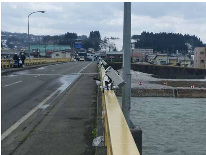
可搬型電波流速計 による観測
