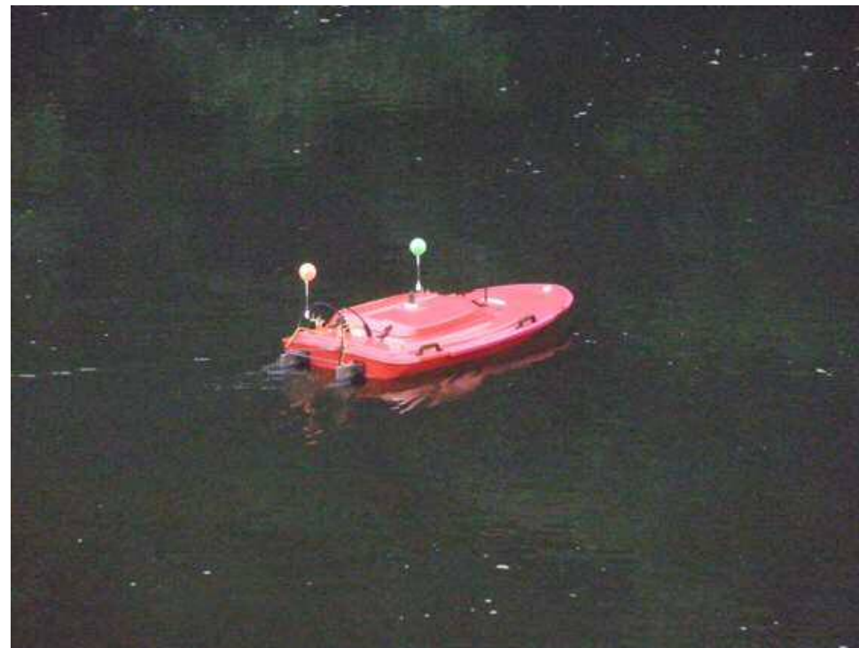
ADCP搭載のラジコンボート
