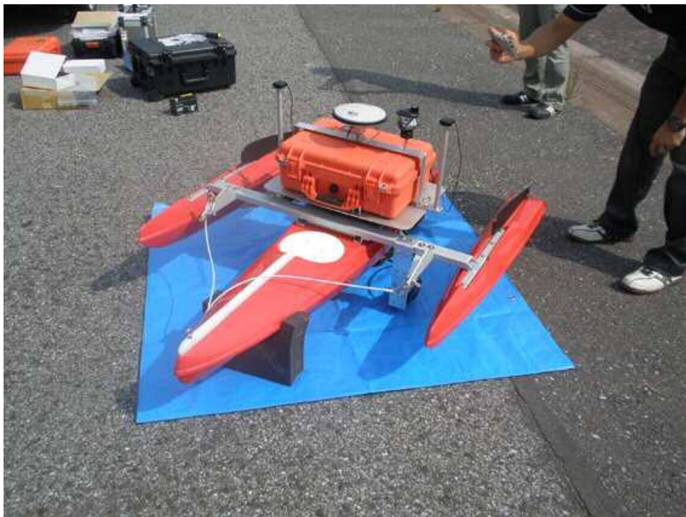
ADCPを搭載した橋上操作艇(高速タイプ)
