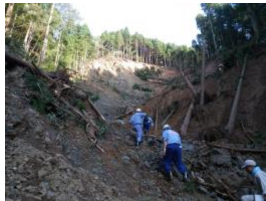
写真 5. 崩壊地 (H=55m、L=100m、W=70m、D max =30m 程度)
