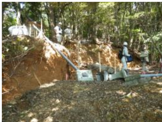
写真 9. 滑落崖頭部の状況 (比高約 2m 程度、伸縮計の設置作業中)
