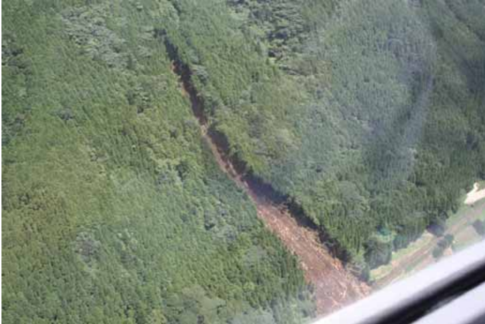
新所地区 全景 斜面中腹で発生し、直線的に下流側まで流下している。
