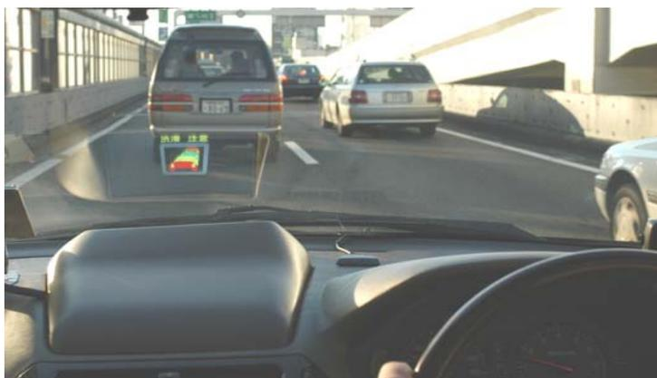
実験車の車載器の表示(ヘッドアップディスプレイ)
