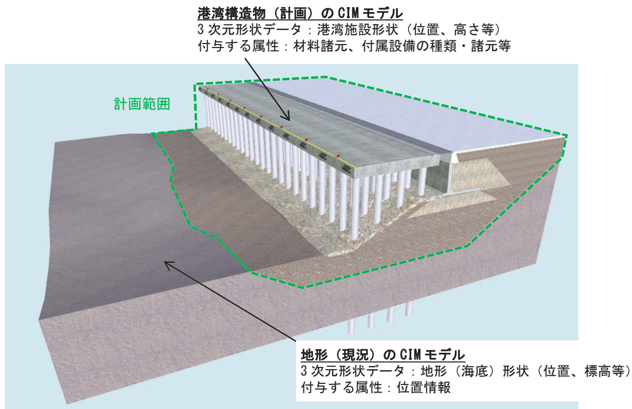
図7 港湾施設 CIMモデルの構造例
