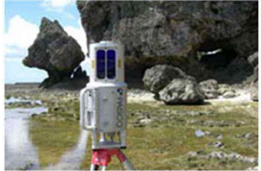
地上レーザ測量の様子
