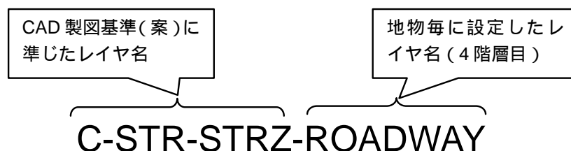
国土交通省の道路工事の完成平面図におけるレイヤ名の例
