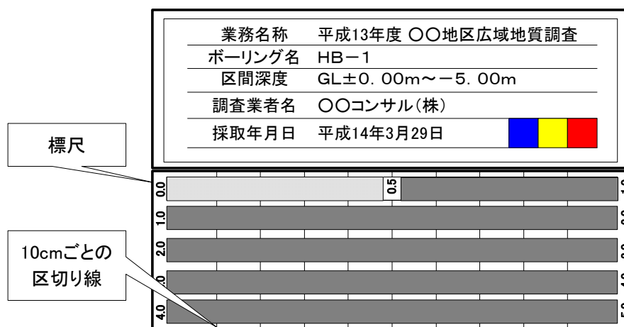
図 5-1 ボーリングコア箱の整理例
