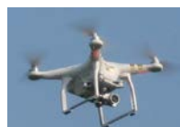
UAV(ドローン等)による3次元測量
