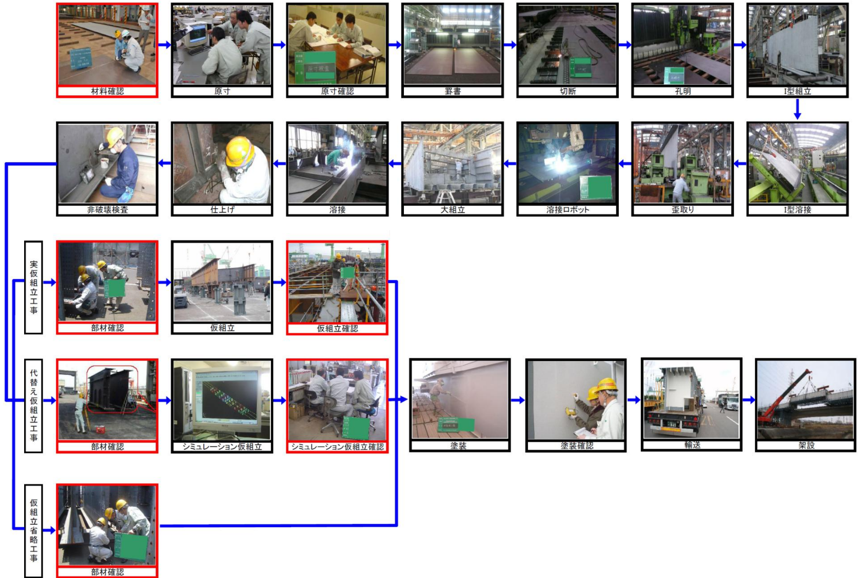
工場製作プロセス フローチャート
