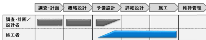
図 3-4 設計・施工一括発注方式の適用事業段階 (イメージ)
