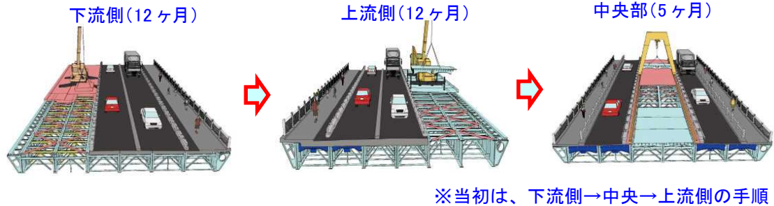
図 7-1-5 採用した施工手順
