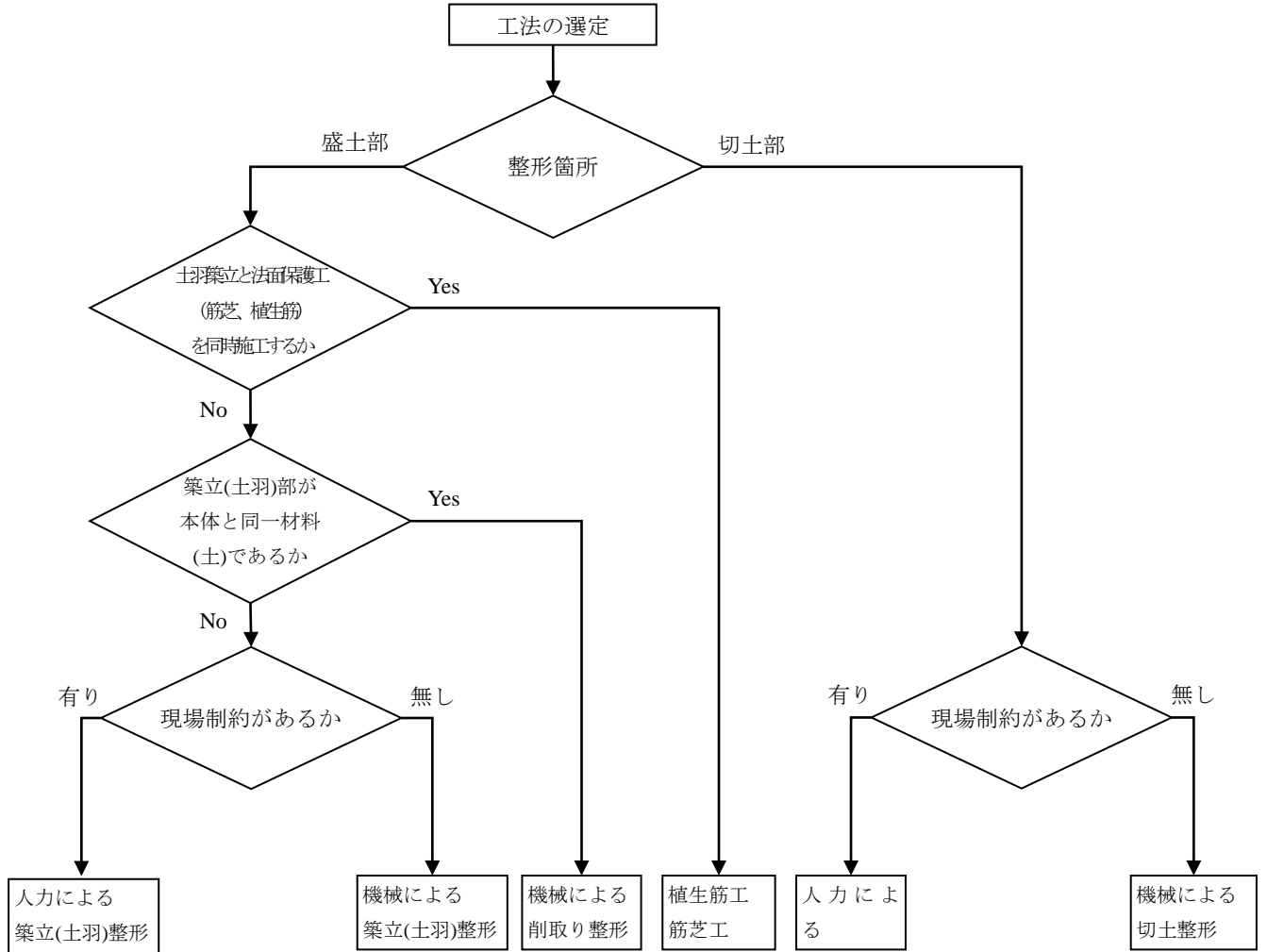
法面整形工 工法選定フロー図
