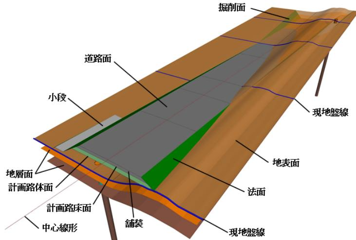
土工（掘削、盛土）や残土処分の数量は、3次元地盤モデルに現地盤線や施工基面（計画路床・河床面）等を表現した土工モデルや構造物モデル等を重ね合わせ、その体積の差分等により算出する。
