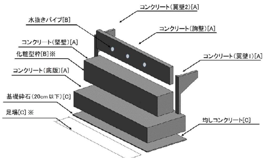
※一般的な土木構造物の「足場」や「型枠」は、数量算出するため「B」を適用する。現場打ち擁壁、函渠工、橋台橋脚、共同溝工等の「足場」や「型枠」は、「コンクリート」に数量が含まれるため「C」を適用する。なお、「化粧型枠」は、数量を算出する必要があることから、本図では「B」を例示している。
