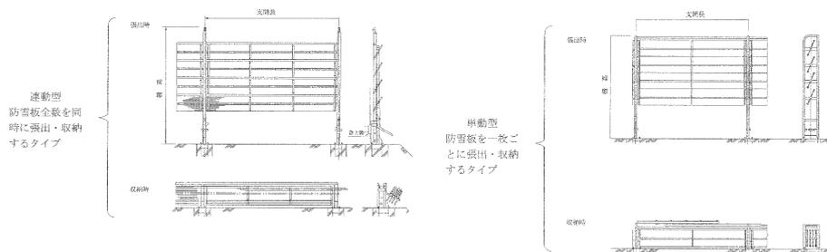
現地収納式防雪柵（吹払式）の概念図 【出典：土木工事標準積算基準書】
