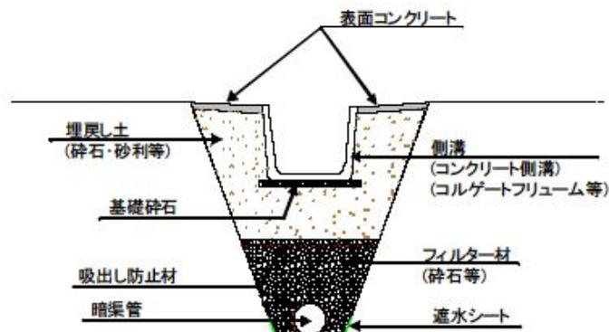
山腹明暗渠の構造概念図 【出典：土木工事標準積算基準書】
