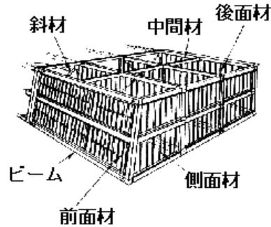
鋼製枠の例 【出典：鋼製砂防構造物設計便覧】
