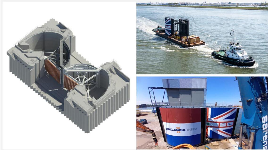
左図©BMMJV：新ゲートの構造 右上下画像©Hollandia Infra：新ゲート輸送の様子
