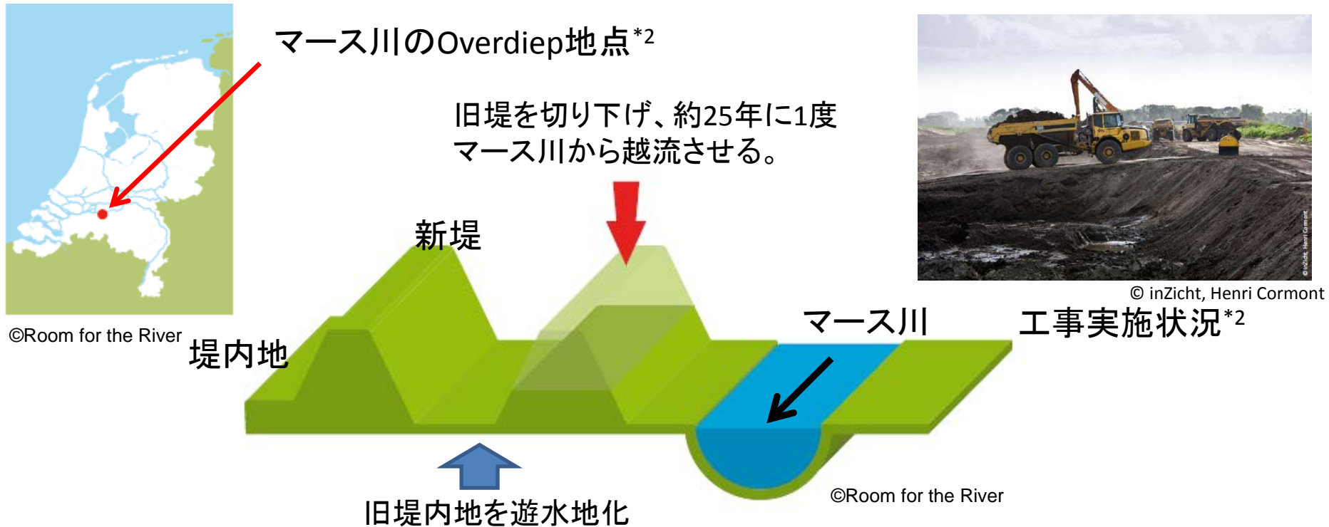
図 マース川Overdiep地点における川の拡張工事概念図（文献 *1*2 より筆者作成）
