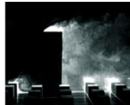
熱を発生している市街地の風の流れを模擬した風洞実験
