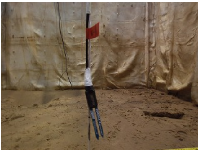
写真 2.3.5 TDR 土壌水分計設置状況
