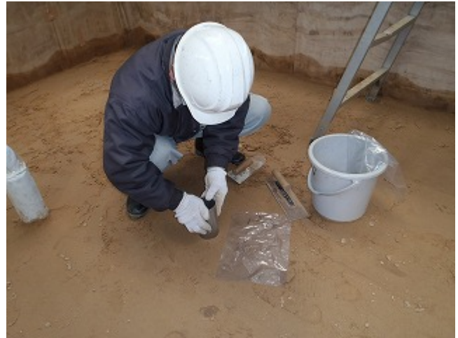
写真 3.8.8 コアカッター密度計測状況
