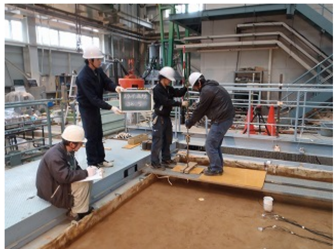
写真 3.7.10 SWS 試験状況 (SW5)
