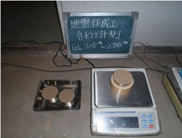
写真 3.8.7 含水比計測状況
