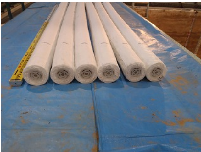
写真 5.1.5 ドレインパイプ底蓋
