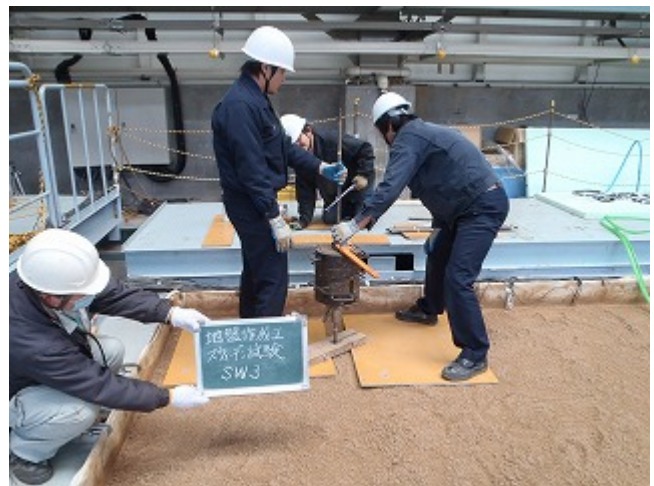
写真 3.8.10 SWS 試験状況 (SW3)
