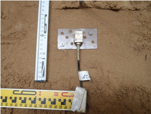
写真 2.3.7 加速度計設置状況
