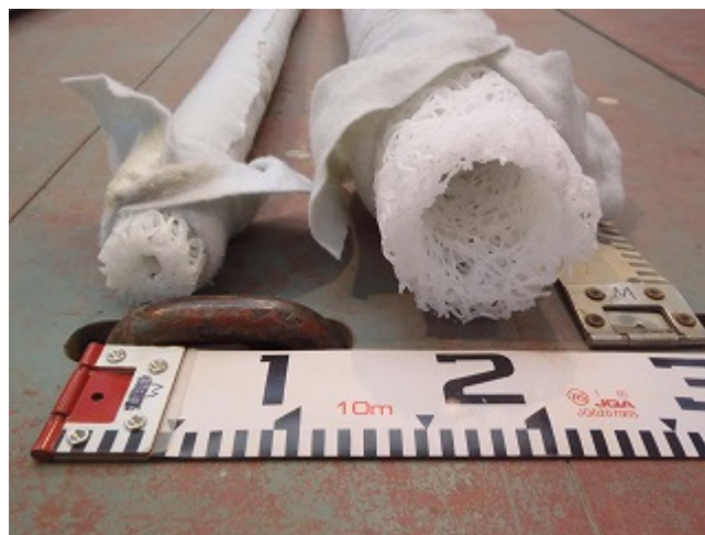
写真 2.2.2 樹脂ストリングパイプ
