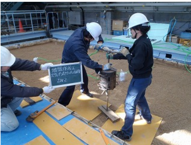
写真 3.8.9 SWS 試験状況 (SW2)
