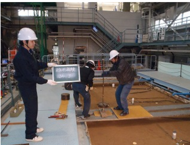
写真 3.7.11 SWS 試験状況 (SW3)
