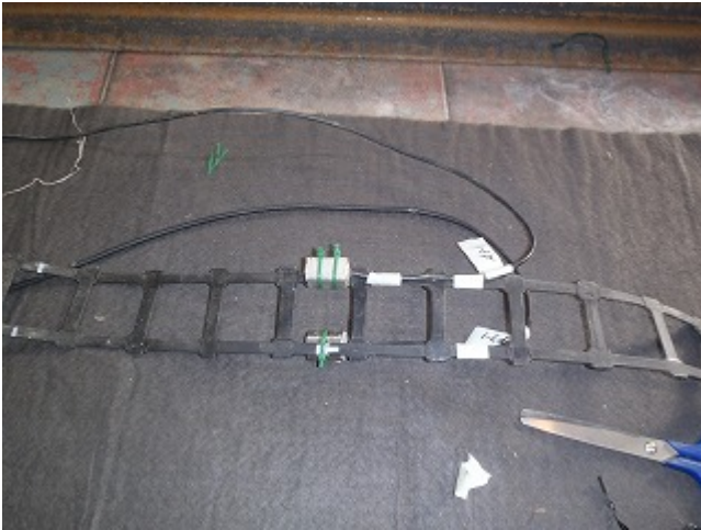
写真 2.3.1 センサー固定状況(加速度計側)
