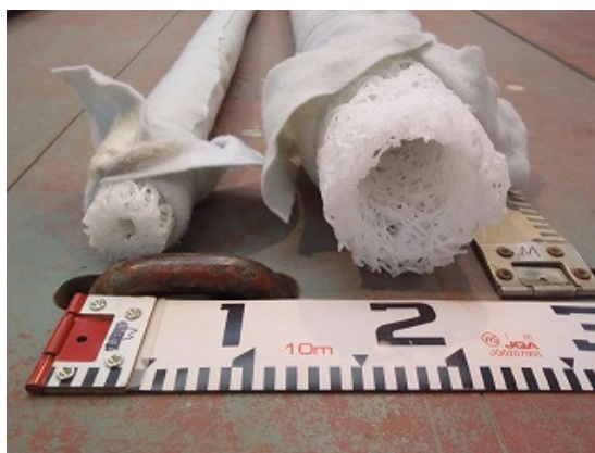
写真3 樹脂ストリングパイプ
