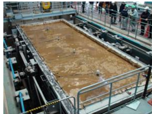
写真1 試験体地盤の外観
