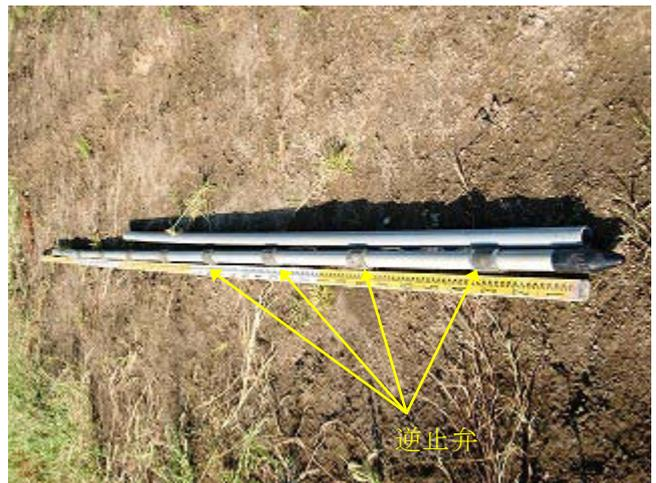
写真 4.9 逆止弁付き外管
