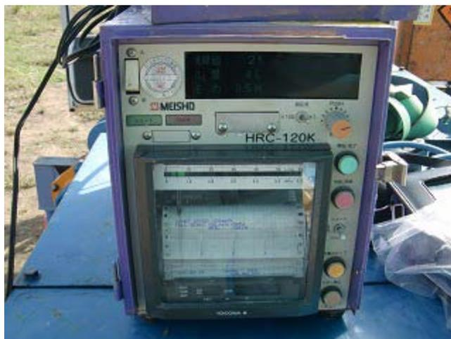
写真 2.18 薬液注入用流量計（記録部）
