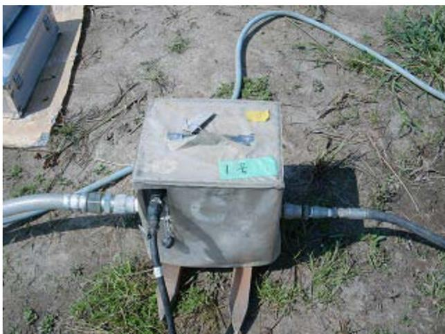
写真 2.17 薬液注入用流量計（検出部）
