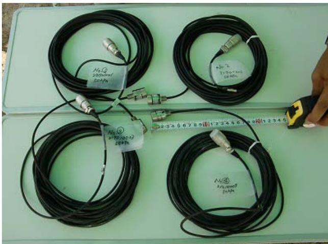
写真 2.23 間隙水圧計
