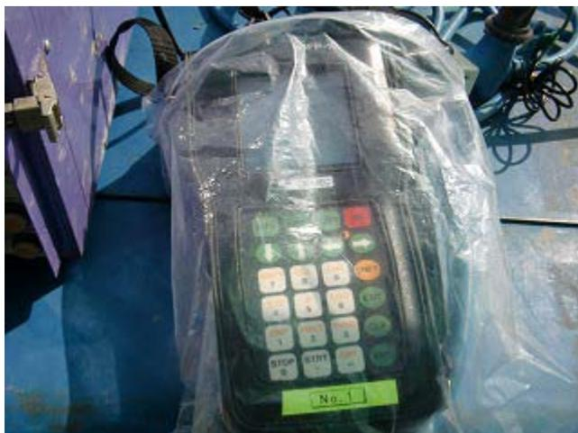
写真 2.20 流量計計測ロガー（超音波）
