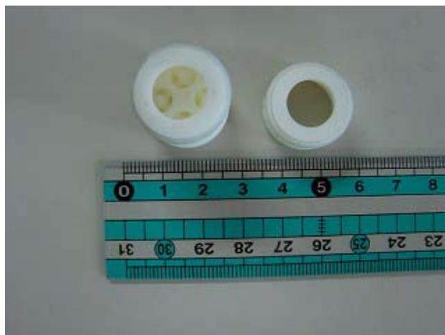
写真 4.5 MB発生ノズル（断面）
