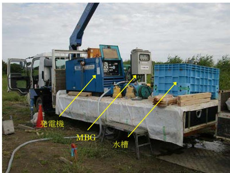
写真 2.26 MB 水注入車上プラントの様子 (4t ユニッック)
