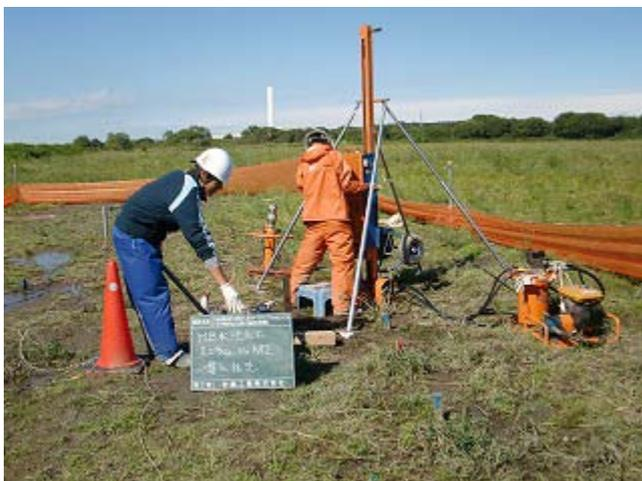
写真 4.12 注水ロッド打設状況
