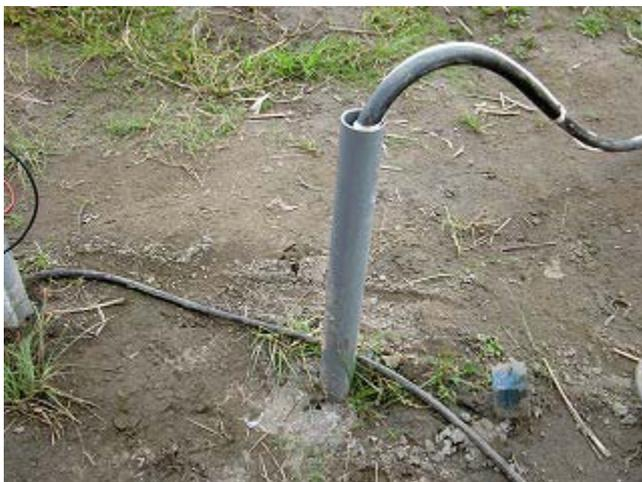
写真 4.10 注入状況 (E1 鉛直管)
