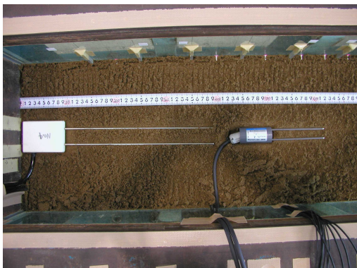
写真 2.2-5 土壌水分計の設置状況
