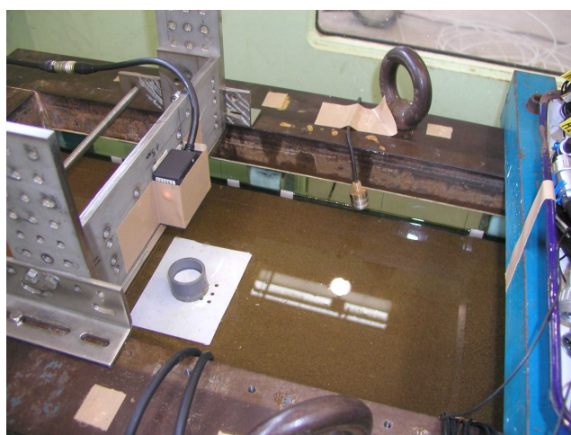
写真 2.3-1 地盤飽和度の測定状況
