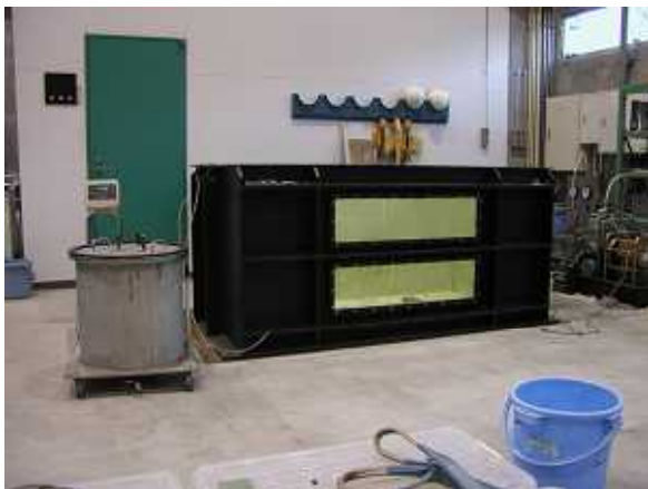
写真 2.2-7 地盤の飽和に用いた脱気槽と注水タンク
