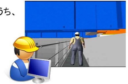
ウォークスルーシミュレーション （「点検のしやすさ」などを設計時に確認）
