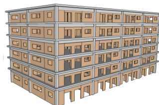
RC柱・梁+CLT袖壁
