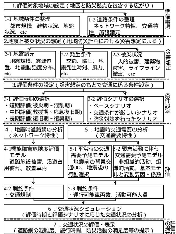
図3 地震時の幹線系道路における交通状況評価
