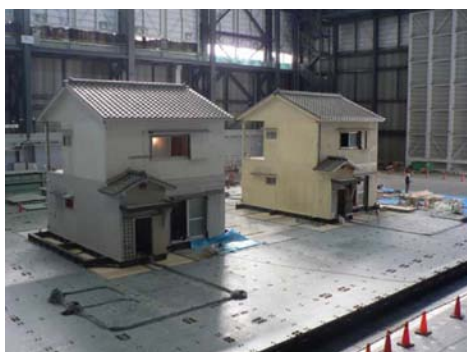
図 3-8 移築補強・無補強実験における試験体の外観
