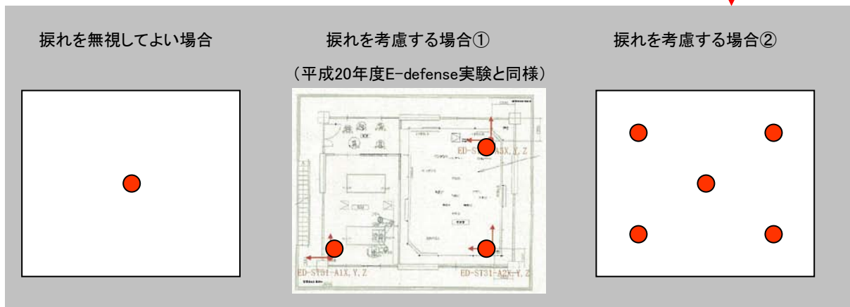
図 3-7 中層 RC 造住宅向け「竹」パッケージにおけるセンサ配置計画
