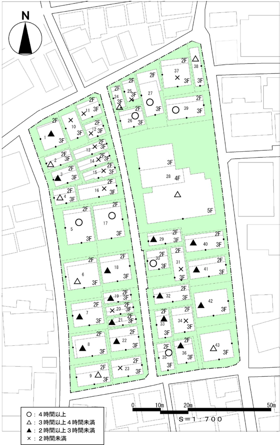
図-3 各敷地での日照時間の評価結果（南面と南側以外面の二面日照）
