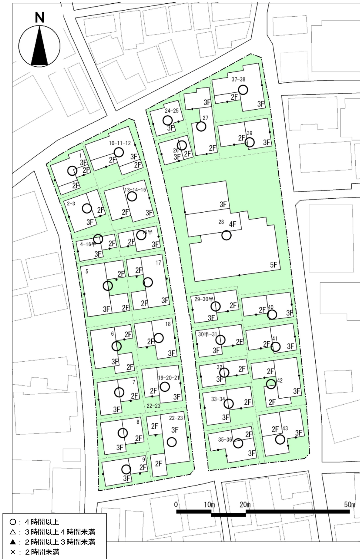
図-4 協調ルールに基づいた街区プランと各敷地での日照時間の評価結果(南面と南面以外の二面日照)
