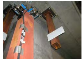
図 センサの外観 （左：加速度計、右：層間変位計）
