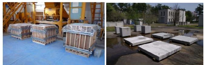
写真 1 コンクリート試験体製作（左）と設置（右）
