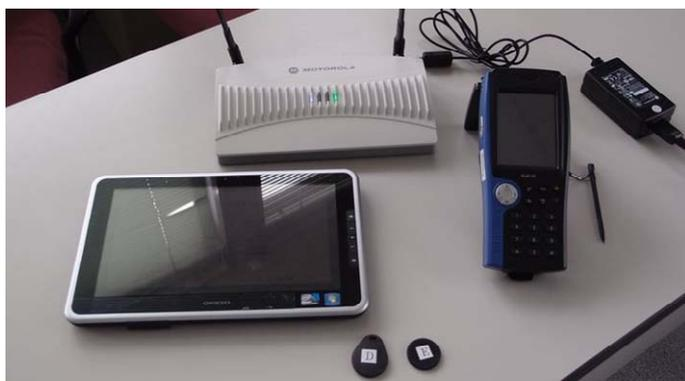
写真 2 UHF 帯 IC タグ用アプリの構成機器
