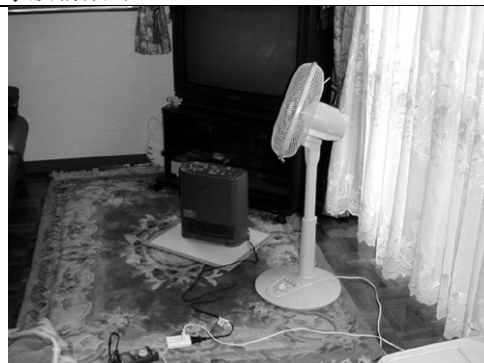
図 15.5.17 熱損失係数測定状況 (1階居間)
