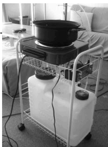
図 8.5.9 水蒸気発生装置
