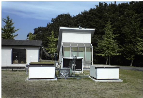
図7.1.7 底面灌水式緑化パレット設置状況
