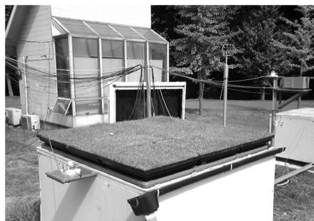
図 7.3.50 緑化給水実測台と実測機器
