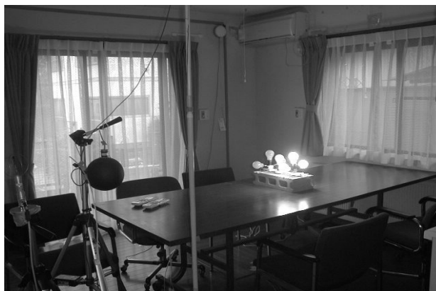
図 4.1.53 室内における発熱の状況
