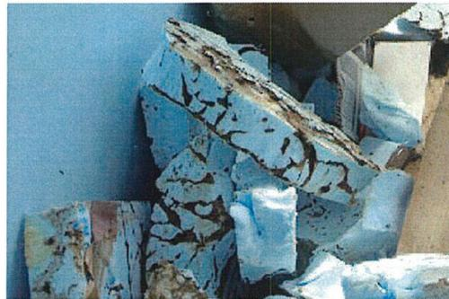
断熱材に構築された蟻道
