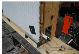
写真 3 モルタル回転拘束治具
