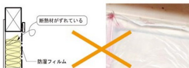
図 5.5 繊維系断熱材による不適切な防湿フィルムの施工例
