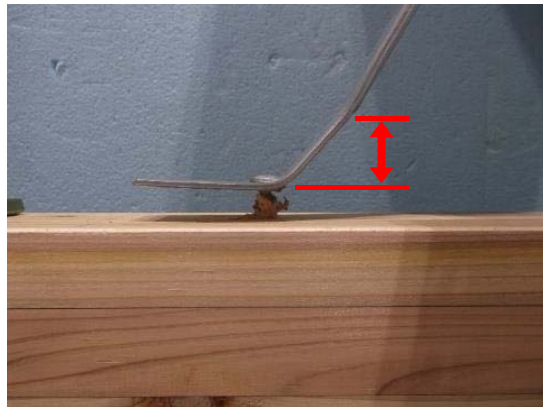
(b) 下底の折れ曲がり位置からねじ留め位置までの距離が 45mm の場合
