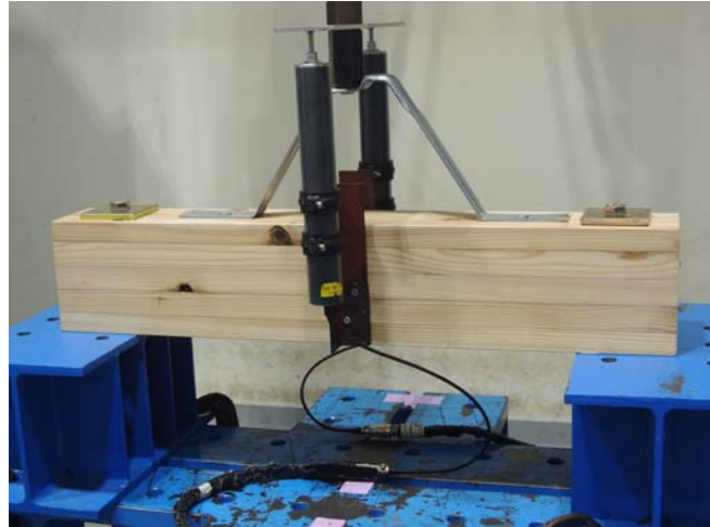
図 4.2 引張試験の実施状況
