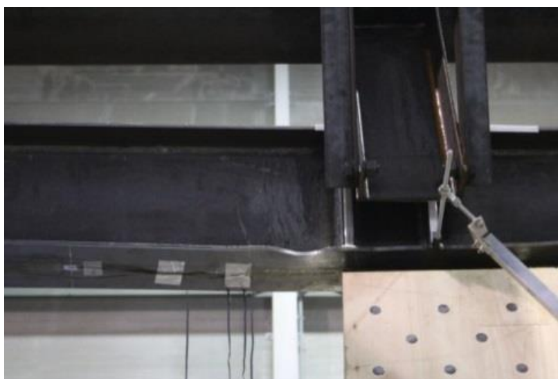
(c) フランジの局部座屈 (9 サイクル目負側)
