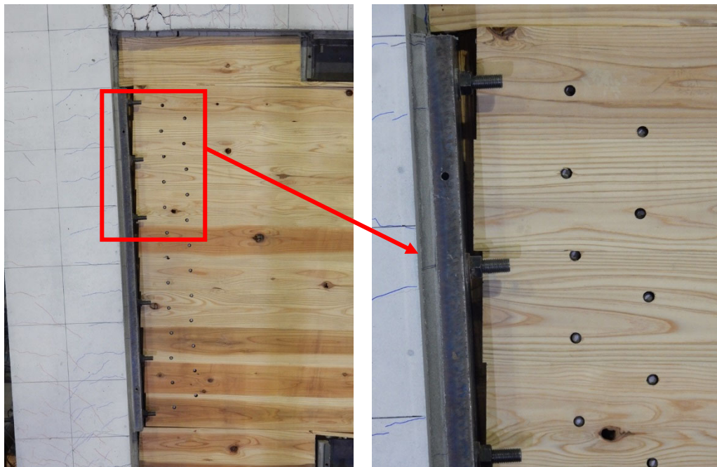
写真 2-34 2F の鉛直接合部における鉄板-CLT 耐力壁間の離間 (R=1/33)
