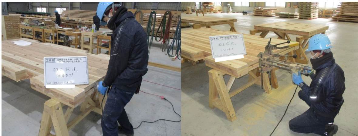
(a) 鉛直接合部取り付け用のスリット孔の加工
