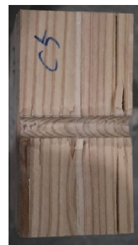
写真 2-18 ドリフトピン面圧試験(内層のみ)における破壊性状
