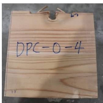
写真 2-16 ドリフトピン面圧試験における破壊性状 (S60-DPC-0 シリーズ)
