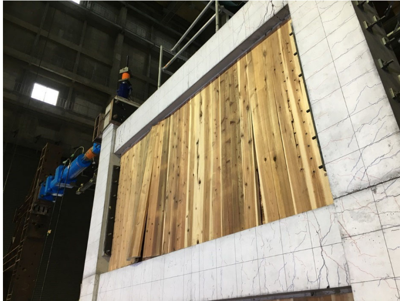
写真 2-44 2F の CLT 耐力壁における最外縁ラミナの面外方向へのとび出し (R=1/33)
