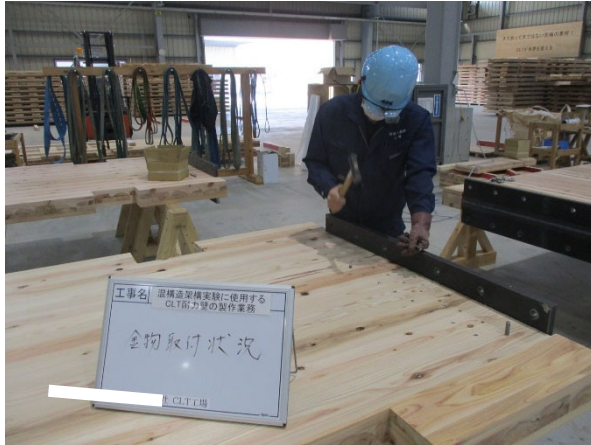
(a) 鉛直接合部取り付け用のスリット孔の加工
