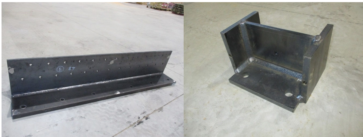
写真 2-2 金物の製作 (左側: 鉛直接合部、右側: 滑り止め)
