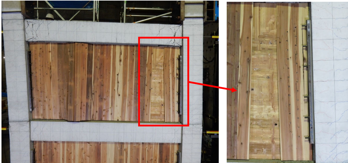
写真 2-44 2F の CLT 耐力壁における最外縁ラミナの面外方向へのとび出し (R=1/33)
