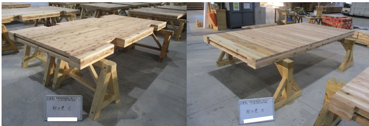
(b) 加工後の CLT 耐力壁の状況 (左側: WA 試験体、右側: WB 試験体)
